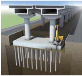
道路橋基礎の補強
