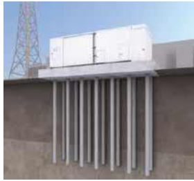
発電所基礎の新設
