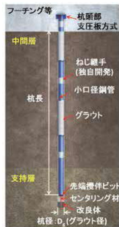
ハイスペックマイクロパイル工法の概要
